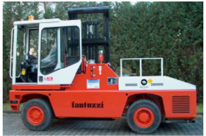
Bild oben: Gesamtansicht des Seitenstaplers mit eingebautem DPF-System.
