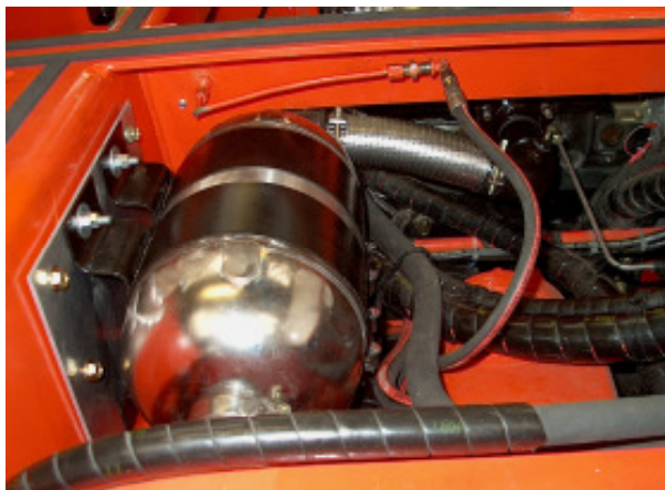
Bild links: Abgriff des Abgasgegendruckanschlusses. Dieser ist mit einem Revisionsstutzen verbunden für Messungen vor DPF (nach TRGS 554). Für den Einbau unseres Filters muß die Hydraulikleitung vom Filter weg verlegt werden.
