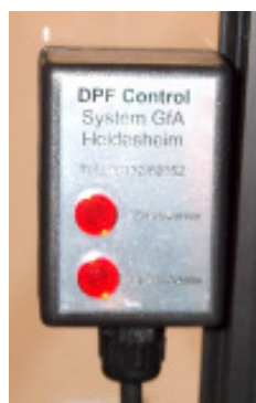
Bilden unten Mitte und rechts: Drucküberwachung gut sichtbar im Führerhaus. Steuergerät montiert im Motorraum.
