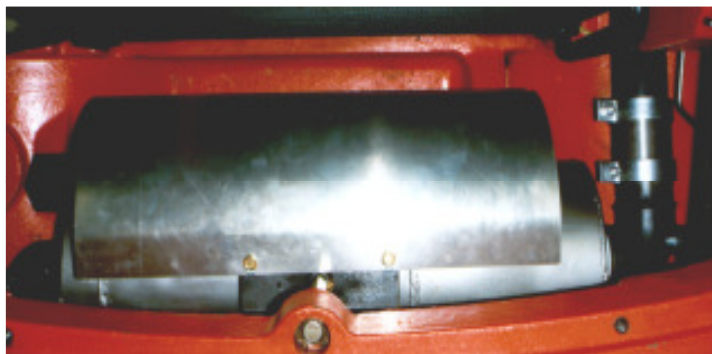
Ansicht von oben auf Luftleitblech mit Befestigung am neuen Halter für DPF.
