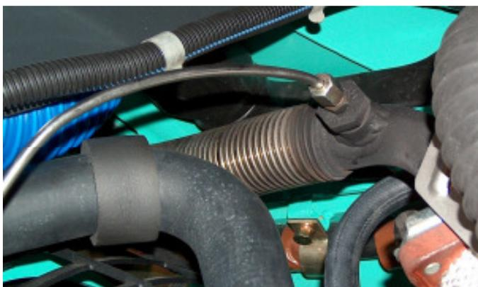
Die Dosiereinrichtung wird durch eine, eigens für Mitsubishi angefertigte, Halterung an die Halterung des Kraftstoff-Filters montiert.
