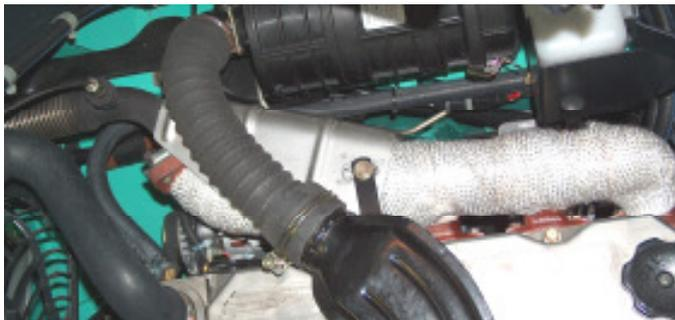
Die Muffe des Abgasgegendruckröhrchens wird auf ein vorgebohrtes  $\varnothing$  13mm Loch an das Krümmerrohr geschweißt.
